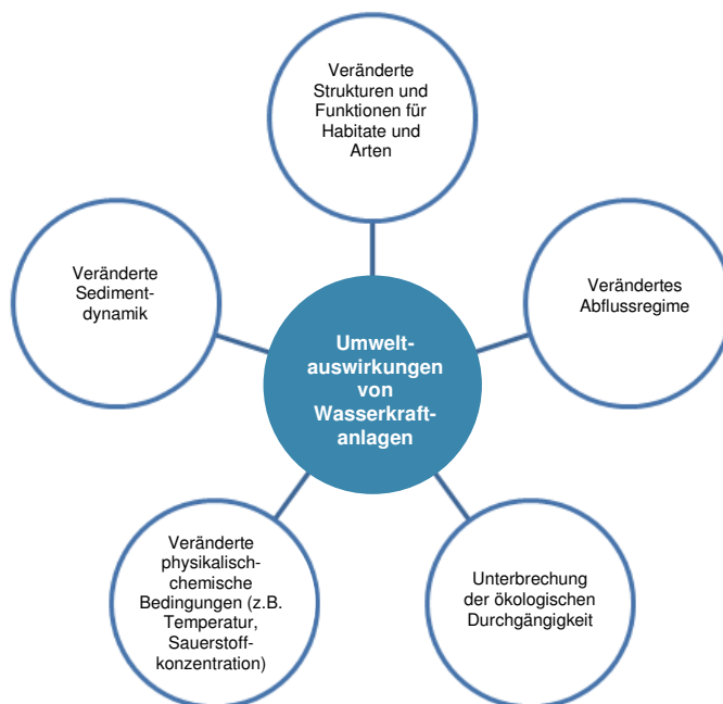
Abbildung 5: Wichtigste mögliche ökologische Auswirkungen von Wasserkraftanlagen – Darstellung des mit Staudämmen typischerweise verbundenen Spektrums möglicher Veränderungen 25
